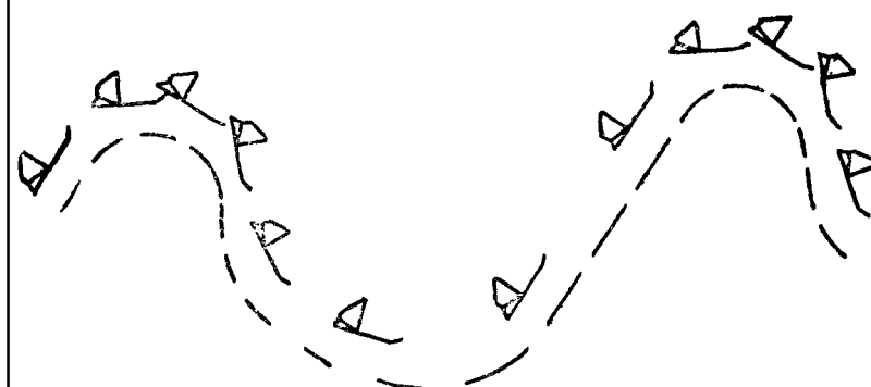
Фиг. 11. Потеряв скорость вследствие крутого взмывания вверх голубь перешел в отвесное падение, но затем, развив скорость, вышел из пикирования, снова взмыл под действием поднятого руля, затем снова потерял скорость и т. д. до самой земли.
